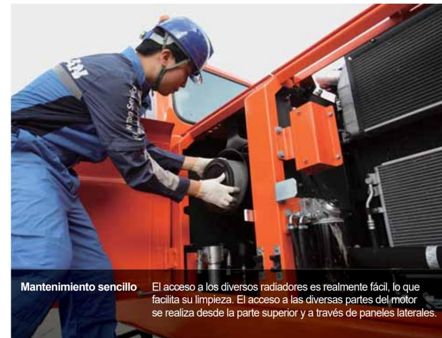
**Mantenimiento sencillo** El acceso a los diversos radiadores es realmente fácil, lo que facilita su limpieza. El acceso a las diversas partes del motor se realiza desde la parte superior y a través de paneles laterales.
