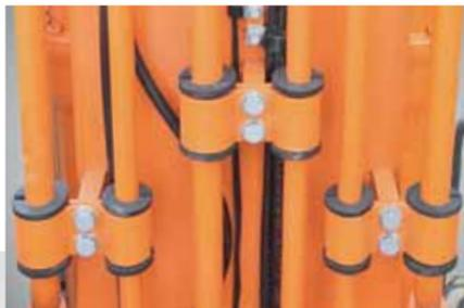
Cubiertas de protección para la pala y el estabilizador
