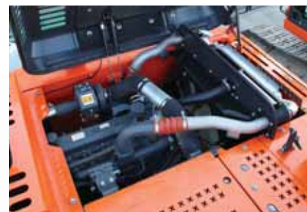
Motor mecánico con filtros de alta eficiencia
