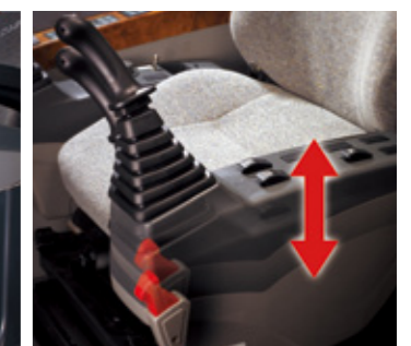
Pedestal de control (función telescópica)
