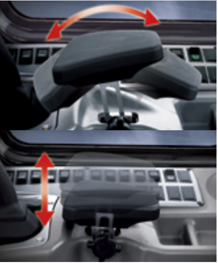
Apoyamuñecas El apoyamuñecas inclinable y telescópico es cómodo para el operador.
