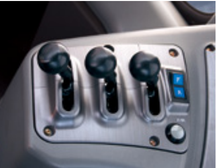
Palancas de control La palanca de mando, que cumple con las diversas necesidades y preferencias de los operadores, garantiza un trabajo más cómodo.
