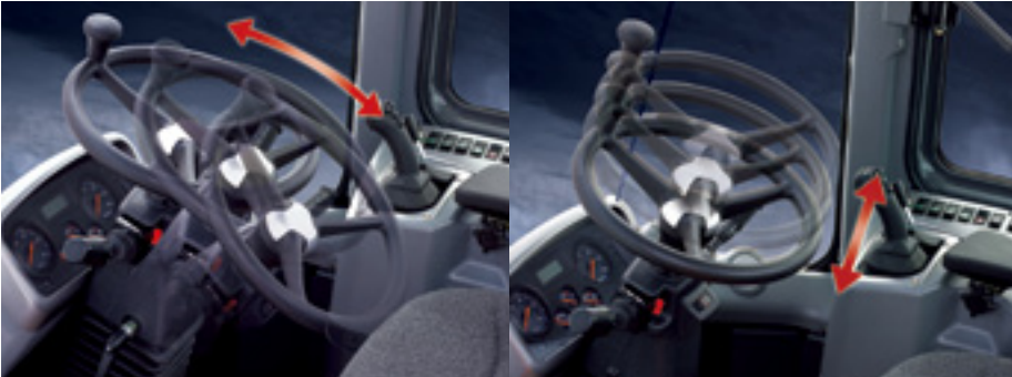
Columna de dirección La columna de dirección puede inclinarse y moverse telescópicamente.
